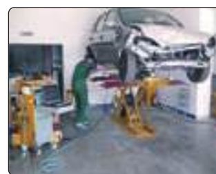
Medición de chasis sobre Minibench
